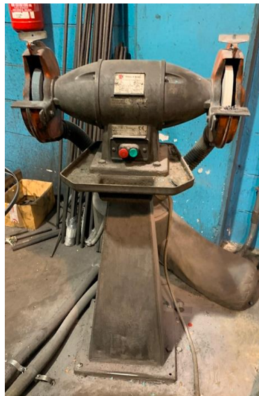
TOMMASI E BONETTI Mod. AT 05 S Potenza 1 HP - 2800 rpm Completa di aspiratore
