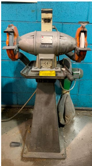
TOMMASI E BONETTI Mod. T 05 S Mola mm 200 x 25 x 20 – 1 HP - 3000 rpm Completa di aspiratore
